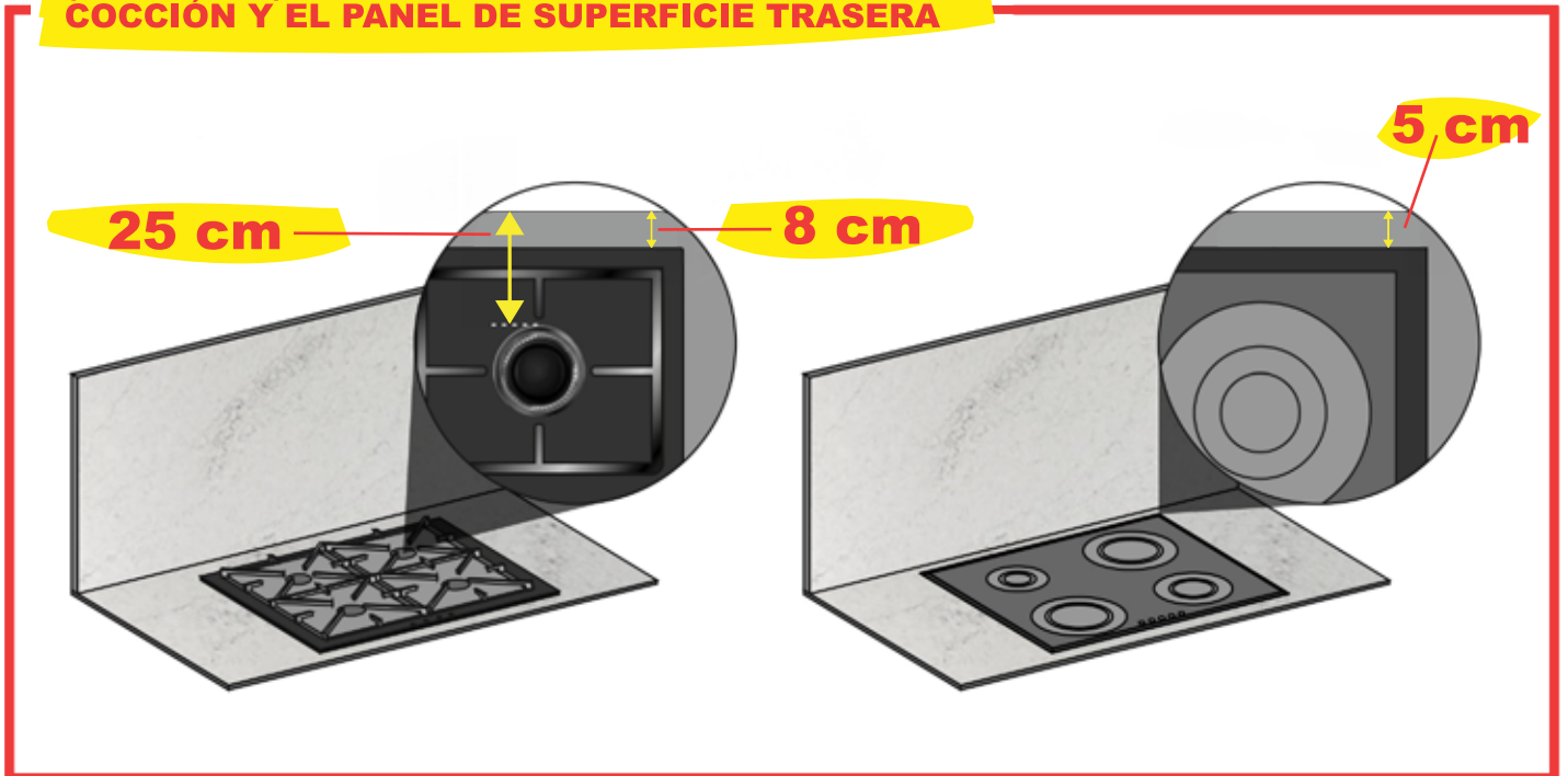
(DIBUJO 12): DISTANCIAS ENTRE LA PLACA DE COCCIÓN Y EL PANEL DE SUPERFICIE TRASERA
